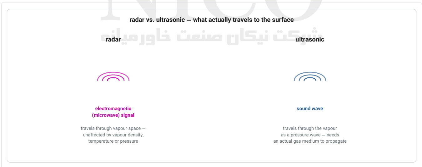
شکل ۷ – نوع سیگنال رادار در برابر التراسونیک و مسیر عبور آن از فضای بخار
