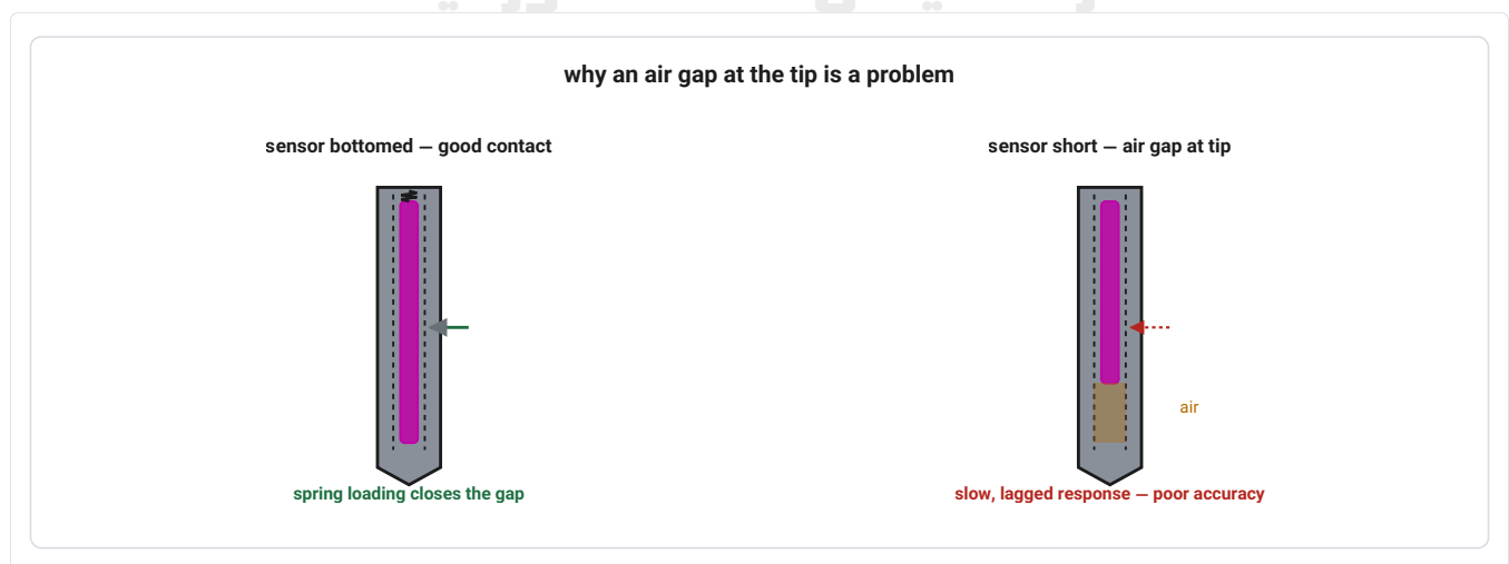
شکل ۸ – تماس کامل نوک سنسور در برابر فاصله هوا و اثر آن بر سرعت پاسخ
